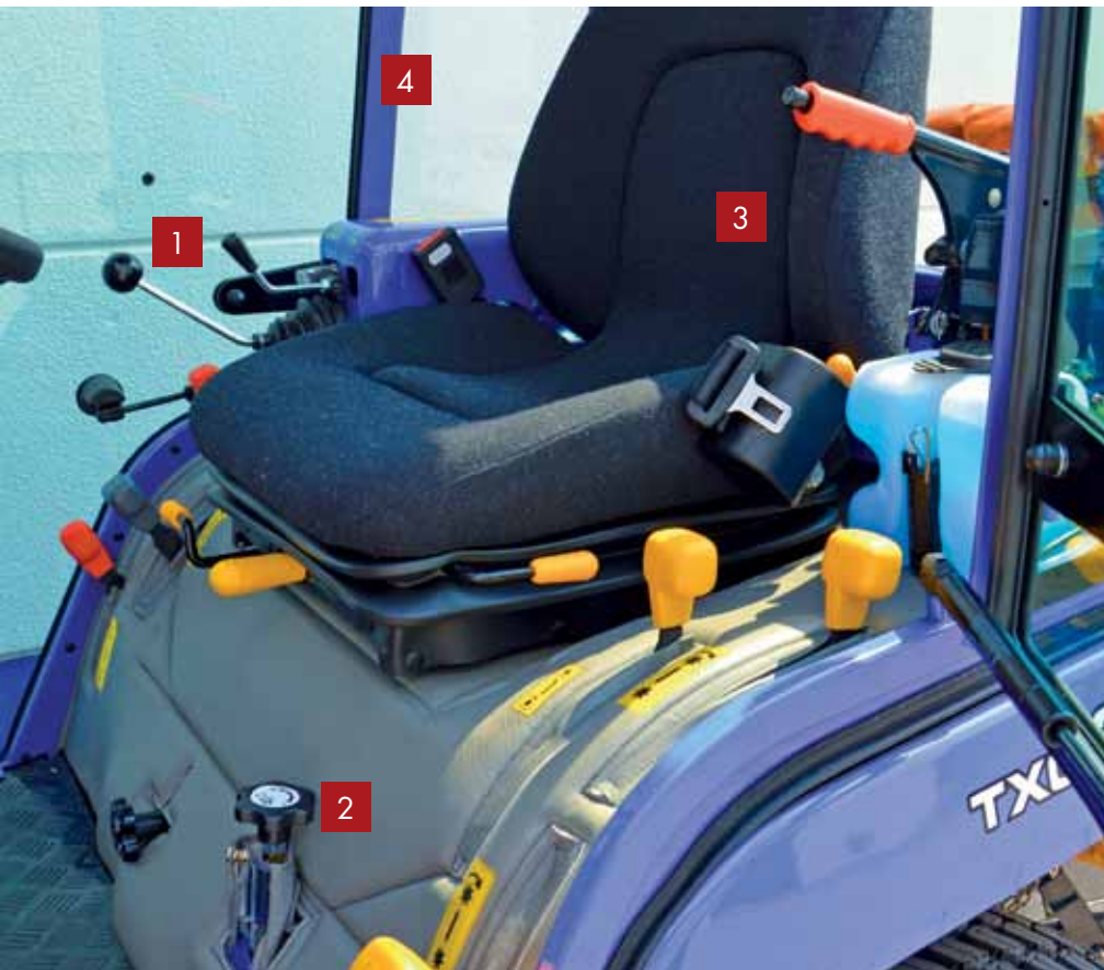
Die Joystick-Kommandozentrale zur kompletten Hydrauliksteuerung.
